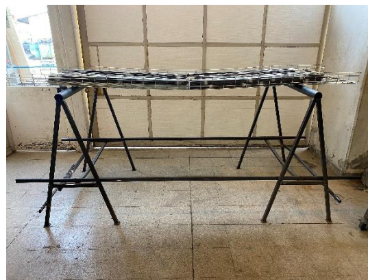
Foto N°4: Muestra con toda la carga aplicada, sin colapso
