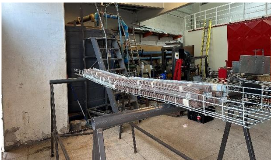
Foto N°4: Aplicación de carga distribuida
