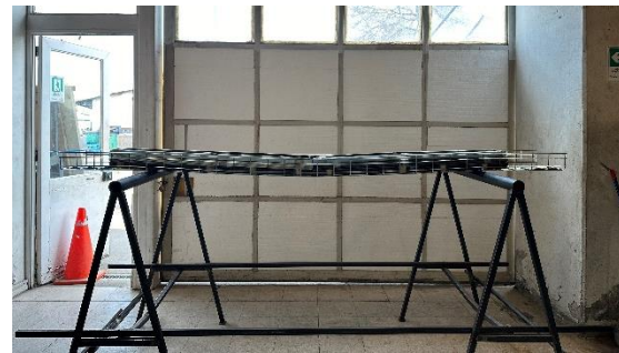
Foto N°5: Muestra con toda la carga aplicada, sin colapso
